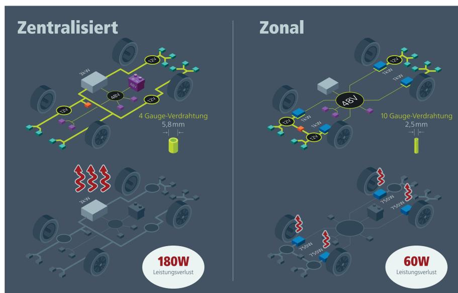
In aktuellen Fahrzeugen kommen zwei verschiedene Power Distribution Networks (PDN) zum Einsatz: das zentralisierte 12-V-Bordnetz (links) und das dezentralisierte 48-V-Bordnetz (rechts). Während das 12-V-Bordnetz auf dicken Kabeln basiert, verwendet das 48-V-Bordnetz dünnere Kabel, was zu einer erheblichen Gewichtsreduzierung, geringerem Wärmeverlust und einem Viertel des Stromstärkebedarfs führt.
