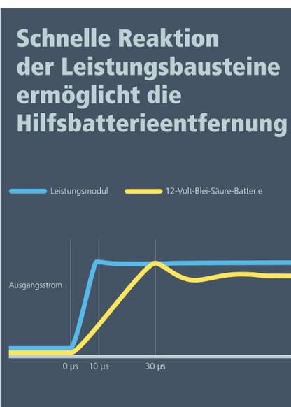
Leistungsmodule weisen ein schnelleres Einschwingverhalten als 12-V-Bleibatterien auf und bilden eine virtuelle Batterie, die die alte, schwere 12-V-Batterie ersetzen kann.
